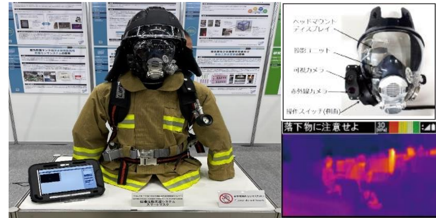
【競争的研究費による研究開発の一例】 現場活動支援システム(スマートマスク) ・ 赤外線映像等による活動支援 ・ 隊長と隊員間での視覚画像の共有 等
